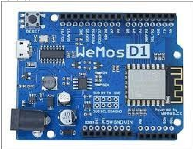
Figura 6: Placa microcontrolador modelo WeMos D1 ESP8266
