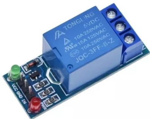
Figura 9: Módulo Relé 1 Canal 5v
